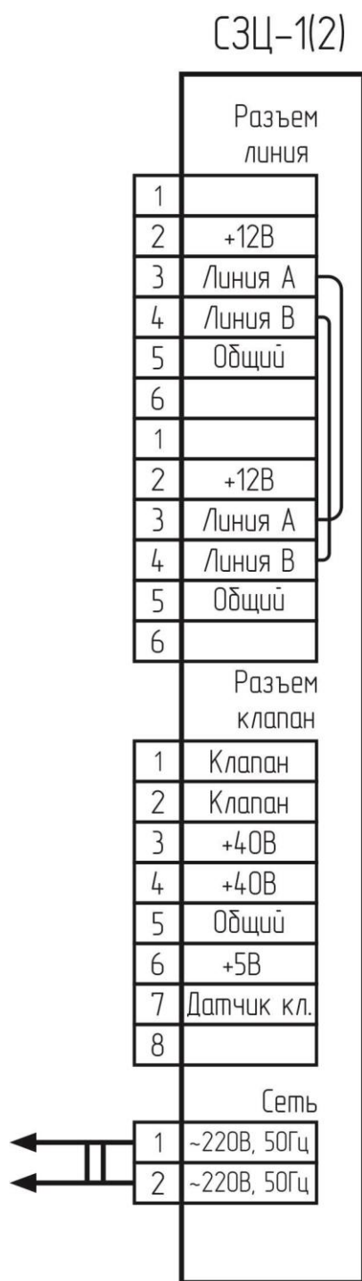
Рисунок Б.1 электрическая схема сигнализатора СЗЦ-1(2).
